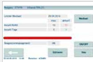
Das Reagenzien-Management-System hilft dem Anwender die genaue Zeit zum Auswechseln der Reagenzien zu planen. Dies sichert reproduzierbare, hochqualitative Färbungen Lauf für Lauf.
