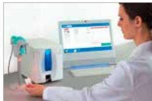
Printtec S wurde speziell für eine schnelle und effiziente Weiterbearbeitung entwickelt. Die Objekträger werden in leicht zu bestückende Magazine eingelegt - sicher vor Staub und anderen potenziellen Verunreinigungen. Der Wechsel der Magazine ist in Sekundenschnelle erledigt, je nachdem ob für eine Studie beschichtete oder unbeschichtete Objekträger benötigt werden. Dank des transparenten Ladeschachtes mit blauer LED-Hintergrundbeleuchtung ist der Füllstand immer leicht erkennbar.
