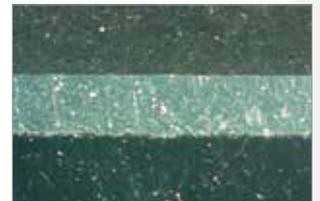
Querschnitt eines Metall / Kunststoff-Rohr-Verbundes um die Schichthaftung zu prüfen und die Schichtdicken zu messen.
