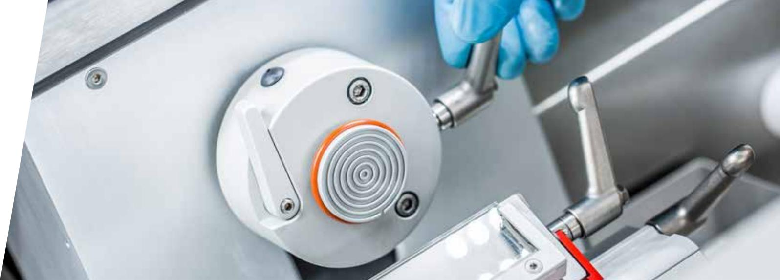
MNT Edelstahl-Kryokammer mit modernem Rotationsmikrotom und Objekthalter
