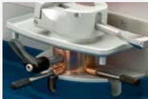
Die Probenorientierung auf der x- und y-Achse erlaubt ein schnelles Ausrichten der Probe in die gewünschte Position.
