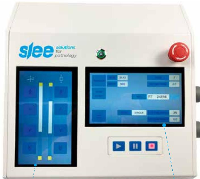
Schnelles Ausrichten der Probe zum Messer über den Touchscreen, der nur die Bewegung steuert
