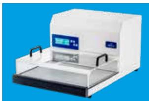
Wenn Sie in Umgebungen mit hoher Luftfeuchtigkeit arbeiten, kann sich Eis auf der Kühlplatte bilden. Um dies zu verhindern, ist eine transparente Abdeckung mit Schiebedeckel optional erhältlich.
