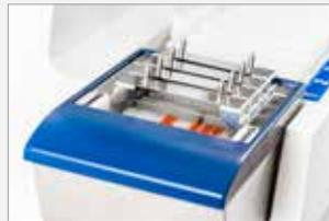
Kontinuierliche Beladung mittels der Ladestation. Körbe werden automatisch aus der Ladestation entnommen, wenn der Cromatec bereit für die nächste Färbung ist.
