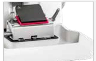
Die große Abfallwanne ist an die Gerätegrundplatte angepasst und fängt die Schnittabfälle während des Schneidens auf. Die Schnittabfallentsorgung ist einfach und schnell.
