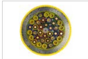
Querschnitt durch ein 8 cm (Ø) Metall / Plastikverbundkabel um es im Auflicht zu analysieren.
