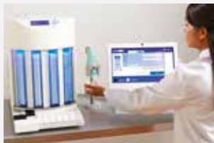
Die Autoloader Version in Verbindung mit dem Printtec C wurde speziell für eine schnelle und effiziente Weiterbearbeitung entwickelt. Die Magazine mit den Kassetten werden einfach in den Ladeschacht eingeschoben.
