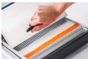
Im Kassettenbereich können Standardkassettenkörbe (wie z. B. vom MTM Gewebeeinbeter) platziert werden. Die MPS W hat einen einklappbaren Deckel zur leichten Befüllung und Bedienung.
