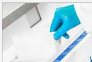
Befüllung der Reagenzien oder Reinigung der Küvetten durch einfache Entnahme. Waschküvetten können freipositioniert werden oder als zusätzliche Färbeküvetten genutzt werden.
