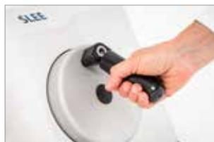
Der Griff des Handrads des CUT 6062 ist zur Erhöhung der Sicherheit bei Betrieb des Schnittmotors einklappbar.
