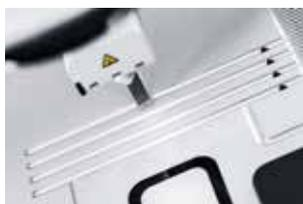
Großer Arbeitsbereich mit integriertem Kühlspot. Über die in den Arbeitsbereich integrierten Ablaufkanäle fließt überschüssiges Paraffin in die herausziehbare Paraffinablaufwanne. Die Fläche bleibt sauber, das Arbeiten und die Reinigung werden so erheblich erleichtert.
